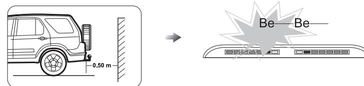
После программирования система будет определять препятствия, игнорируя выносные элементы автомобиля.
