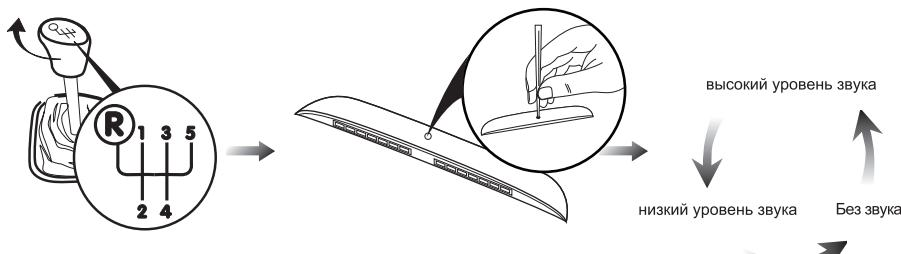
Включите зажигание, и нажмите кнопку регулирования громкости звука, что бы выбрать наиболее подходящий уровень звука или же выключить звук.
