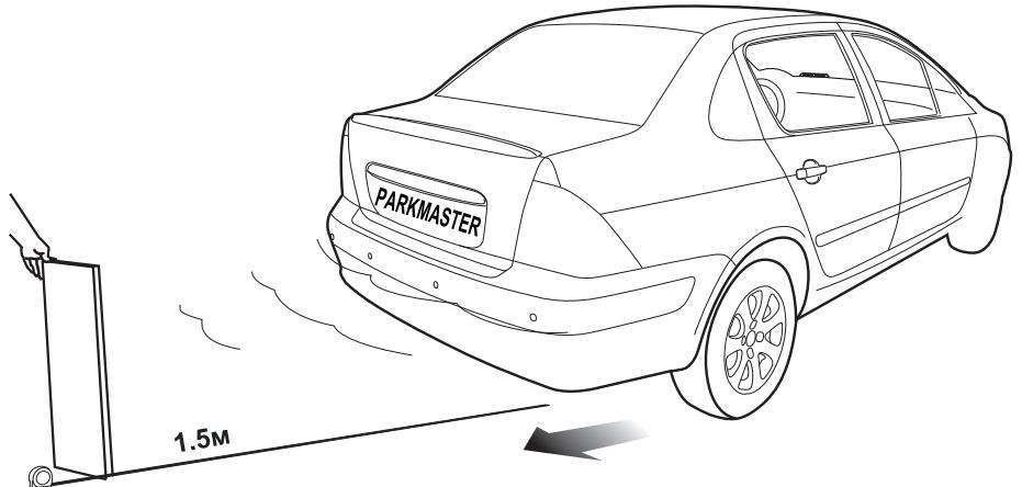
Данный тест возможен с применением плоской деревянной доски размерами (30x100см) держите позади автомобиля и управляйте автомобилем для проверки каждого датчика системы, как показано на рисунке.
