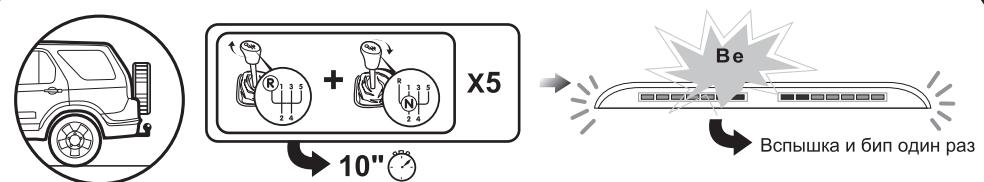
Включите зажигание, переместите ручку коробки передач из позиции «N» в позицию «R» и оставьте в позиции «R» до включения индикатора, повторите процедуру 5 раз. На 5 раз, удерживайте ручку коробки передач в позиции «R» пока индикатор не просигнализирует звуковым и световым сигналом один раз. Это означает, что функция запоминания прошла успешно, и система не будет реагировать на выносной элемент автомобиля.
